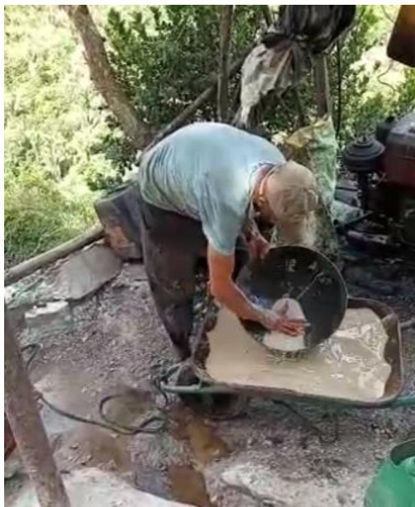
Figura 20 - Realização da concentração por bateamento
