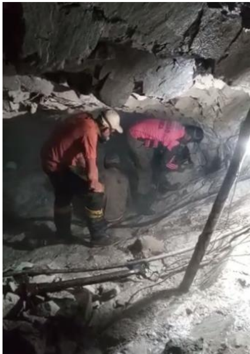
Figura 11 - Perfuração da rocha com martelete pneumático em frente de lavra subterrânea
