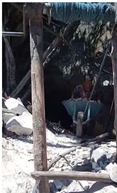
Figura 14 - Remoção do minério por carrinho de mão com auxílio de cabo
