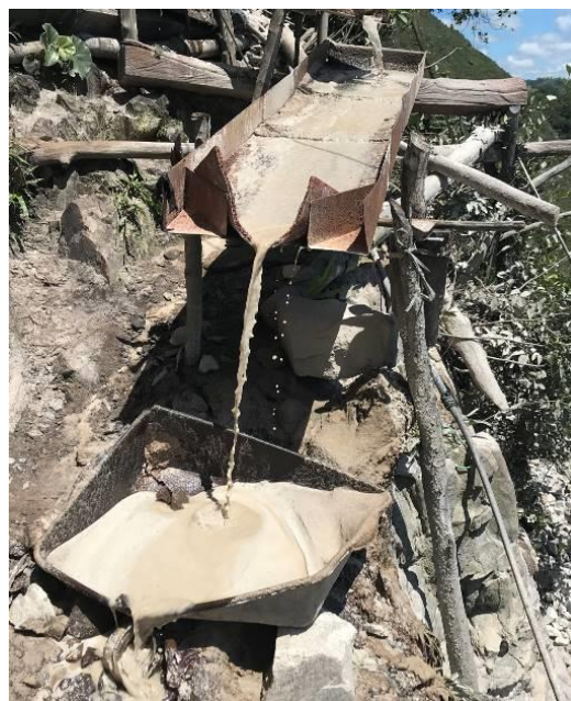
Figura 19 - Recipiente de acúmulo da fração de minério triturado de menor densidade após passagem pelas calhas/tapete
