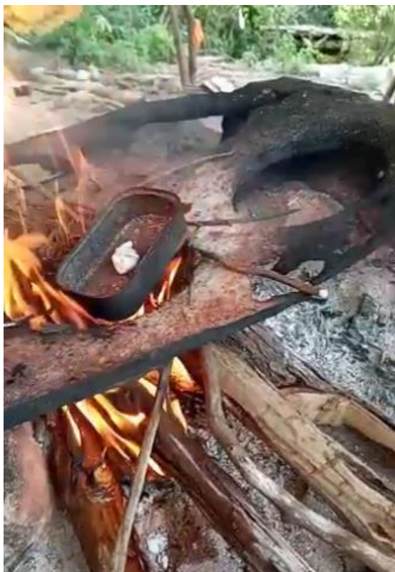
Figura 21 - Decomposição térmica da amálgama sendo realizada no acampamento
