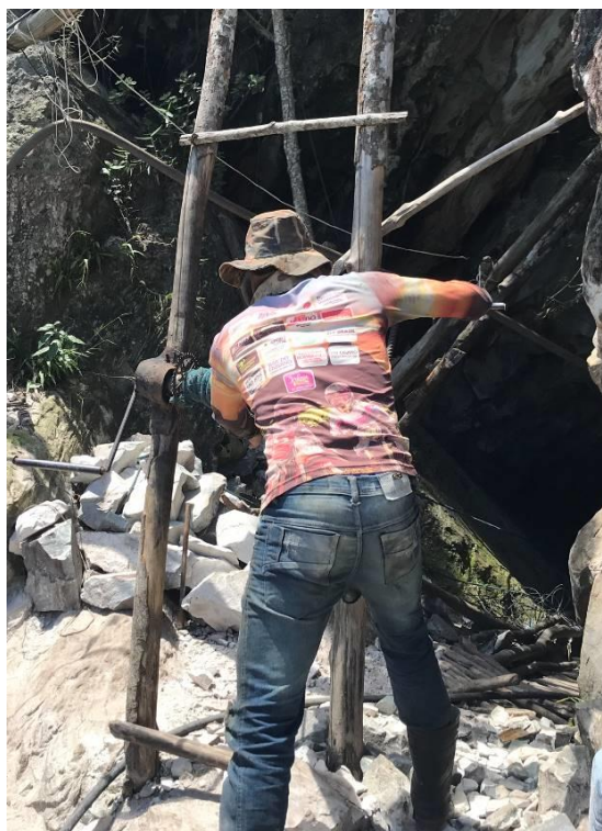
Figura 15 - Trabalhador realizando tração manual para retirada do carrinho carregado de minério do interior da gruna
