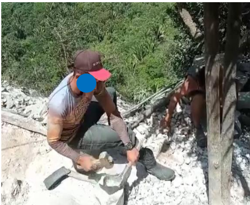
Figura 16 - Processo de cominuição manual do minério
